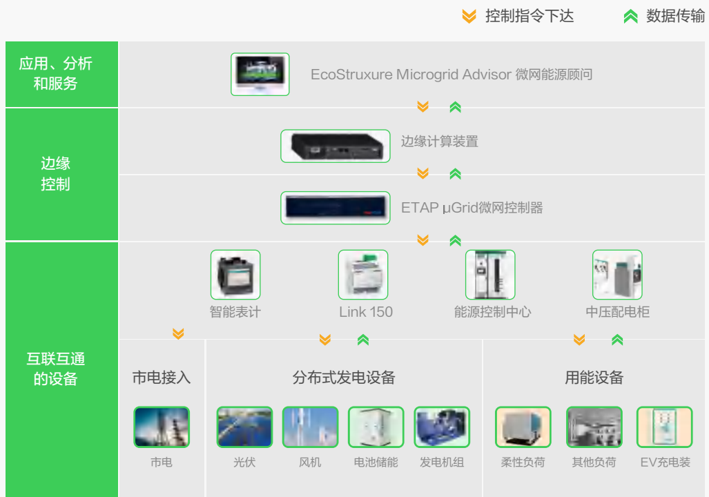
(图20 典型的微电网系统三层架构)
